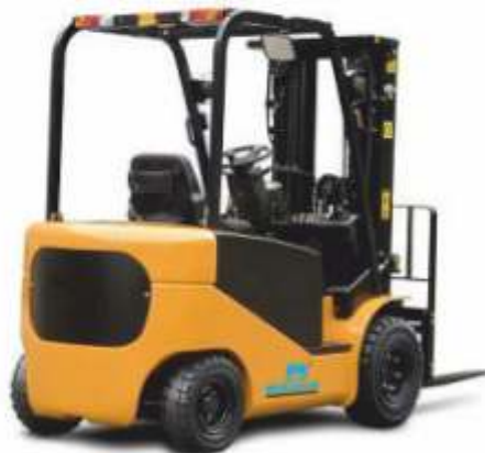
Model : NK15E / NK25E / NK30E / NK50E Capacity upto (kg) : 5000 • Lift Height upto (mm.) : 6000 Mast : 2 Stage / 2 Stage FFL / 3 Stage FFL • Drive Option : DC / AC
